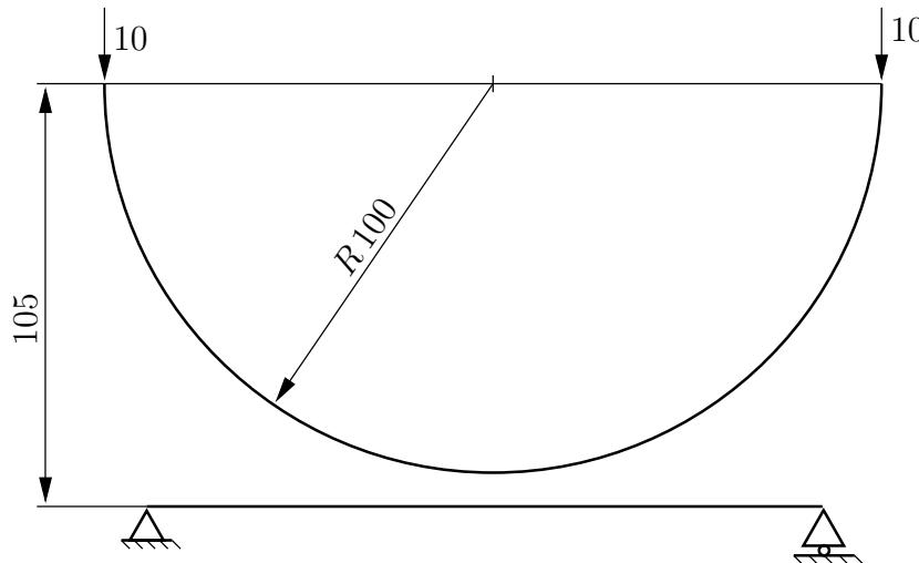
4.2. ábra. Rugalmas lemezek érintkezése(szélessége:  $2 \times 10\text{ mm}$ , vastagság:  $0.5\text{ mm}$ )
