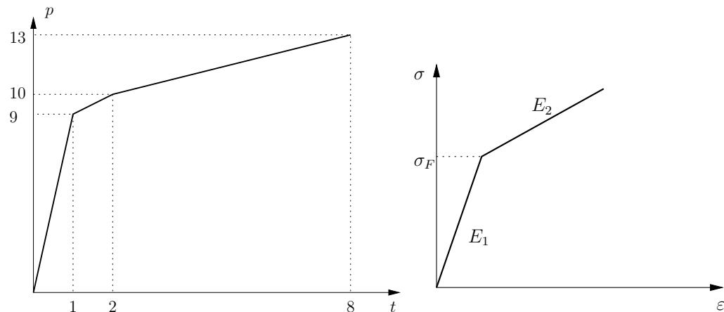
7.2. ábra. Terhelés – idő diagramm; Feszültség – nyúlás diagramm
